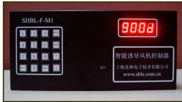
左图：诱导风机智能控制器一分控（尺寸：180×120×50 单位：毫米）
